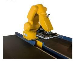
Mit Deep-Learning-KI-Algorithmen werden die Massenstromartikel dann von 3D-Kameras erfasst. Die Software lokalisiert die Artikel im Stapel und erkennt deren Position und Größe. Ein neuronales Netzwerk teilt den Robotern mit, welche Pakete sie kommissionieren sollen. Sie werden dann auf ein zweites Förderband gelegt, komplett ausgerichtet und vereinzelt, sind bereit für die automatische Einbindung in ein Erfassungs- und Sortiersystem.
